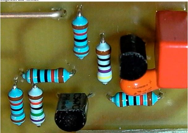
Anschließend werden die Kondensatoren bestückt. Es handelt sich hier um einen Folienkondensator C1 470nF und einen Tantal-Kondensator C2 mit  $10\mu$ F. Der Tantal-Kondensator ist gepolt und darf nicht falsch bestückt werden.
