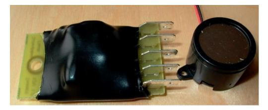
Der Anschluss ist denkbar einfach, es werden die 12V + Spannungsversorgung vom Akku an den Anschluss (12V +) aufgelegt. Die (Gehäuse)masse wird an den Anschluss (GND) aufgelegt. Jetzt fehlt nur noch der Draht zum Blinkerschalter, und fertig.
